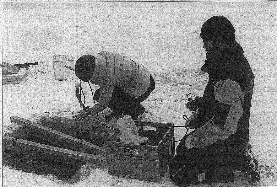
Lammin biologinen asema testasi viime talvena Leväsieppari-hankkeessa, voisiko keinovalolla tehostaa levien kasvua. Kuvassa Elina Tuominen ja Esa-Pekka Aaltonen Lammin jätevedenpuhdistamon jälkikäsitteilyammikolla valaistujen näytepullojen tilaa tutkimassa. Hanke on päättymässä maaliskuussa.
