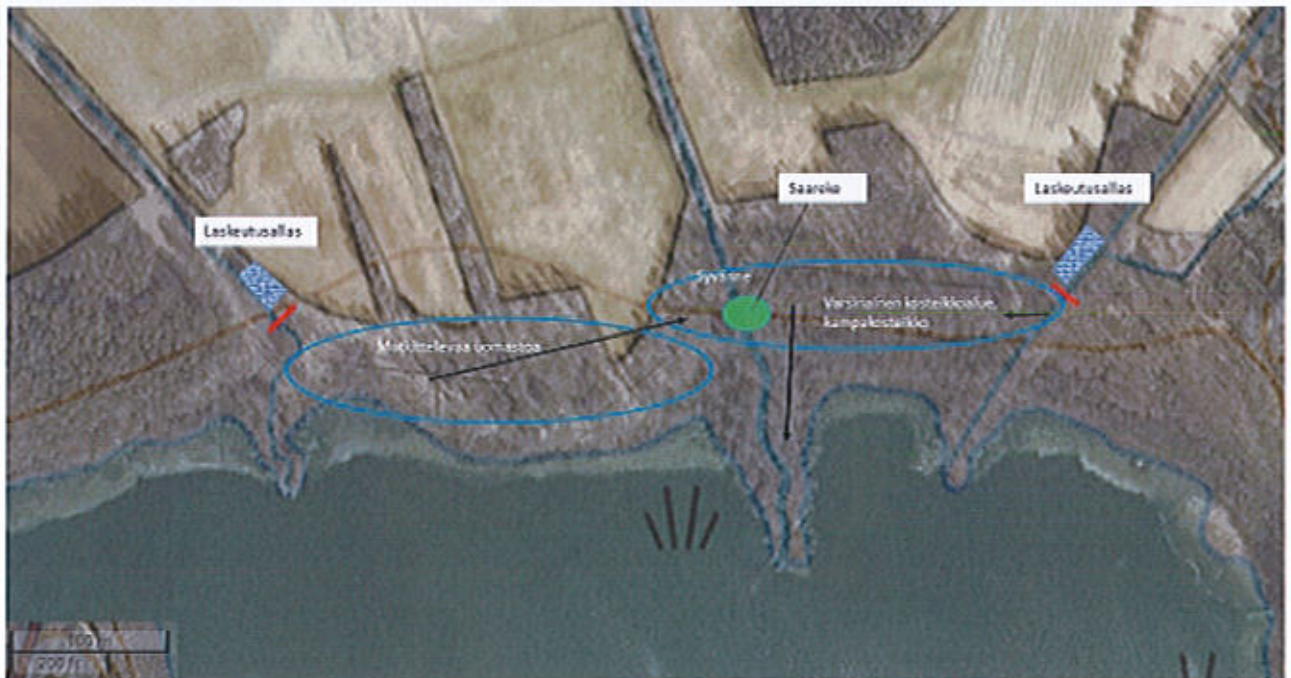
Kuva 8. Kosteikon periaatepiirros, rakenteet ei mittakaavassa. Punaiset viivat ovat pohjapadot,
