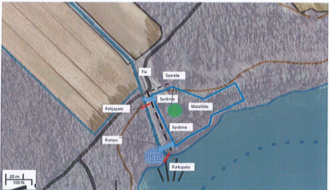
Kuva 12. Kaivettava kosteikkoalue esitetty sinisellä, jätettävä saareke (puu) esitetty vihreällä, punaisella pohjapatojen paikat, sinisillä nuolilla tien alittavat rummut. Sinisellä kuviolla laskeutusaltaan paikka. Tiet on esitetty katkoviivoilla. (©maanmittauslaitos, Syke)
